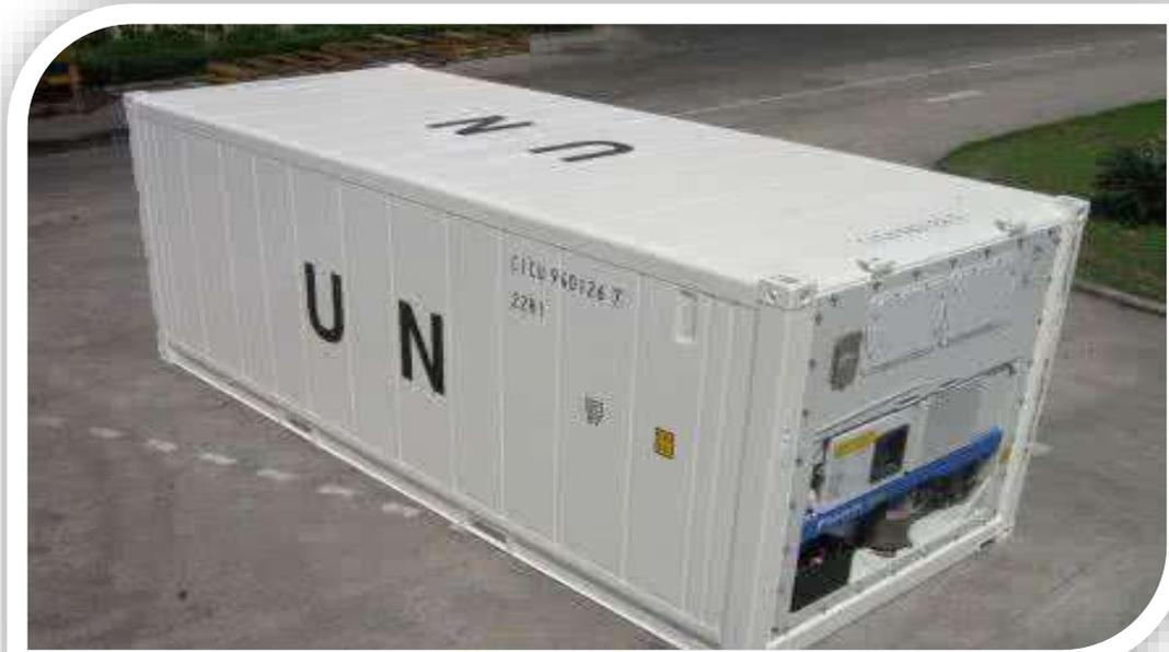
运输的各环节保证全天候地监控冷藏箱；冷藏箱的电脑机组精确地控制、记录温度；经验丰富的专业员工和技师在运输过程中专门负责冷藏箱。
